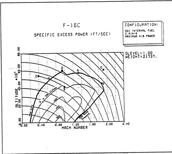
FIGURE 9.20 F-16C lg SPECIFIC EXCESS POWER
