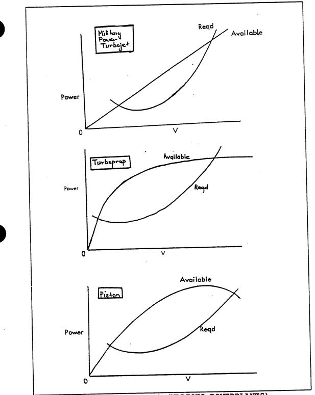
FIGURE 9.7 P. AND P. CURVES (VARIOUS POWERPLANTS)
