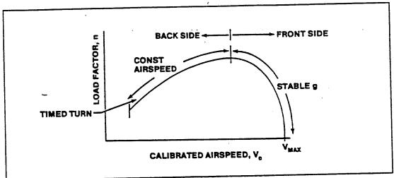
FIGURE 9.49 STABILIZED TURN TEST METHOD
